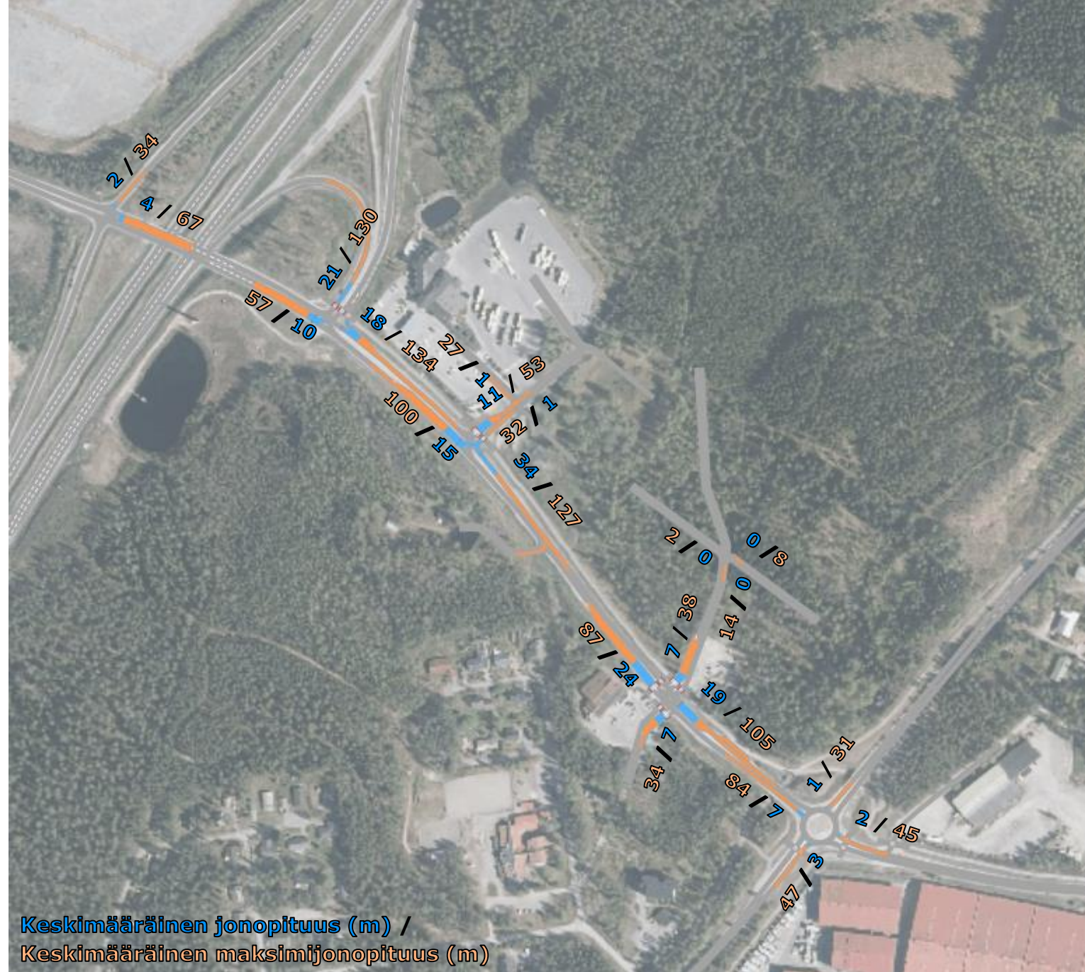
Kuva 13. Vuoden 2060 iltahuipputunnin aikana muodostuvat jonopituudet tilanteessa, jossa Kivimäen asemakaava-alue on rakentunut kehityskuvan 1 mukaan.
