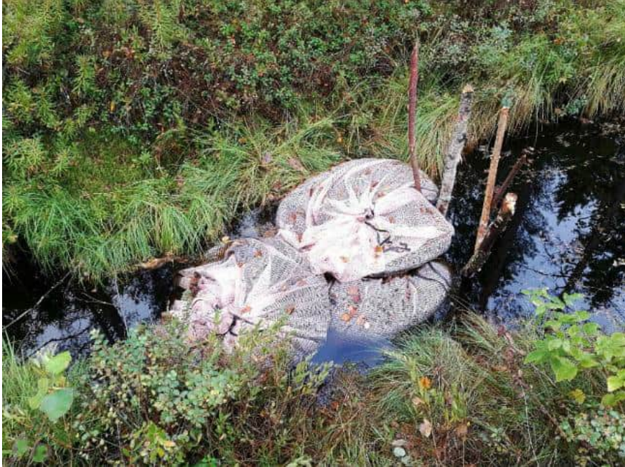
Kuva 9. Biohiilellä täytettyjä suodatinsäkkejä metsäojassa. Säkit on tuettu hitaan virtaaman ojassa pystypuilla (kuva: Petrina Köngäs).
