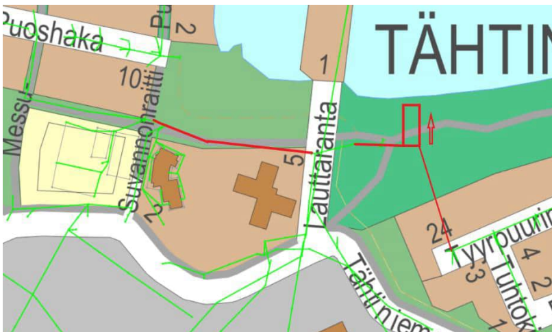
Kuva 7. Punaisella uudet hulevesijohto liitännät sekä altaiden sijainti. Punaisella esitetty veden virtaama suunta
